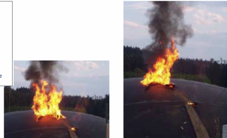
Bild 10 + 11: 6. Brandversuch ein brennender benzingetränkter Lappen wird auf den Foliengasspeicher geworfen
